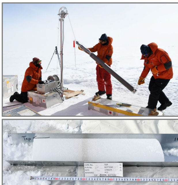
図 1: 第 59 次南極地域観測隊による NDF 地点(図 2(B)を参照)での NDF2018 コアの掘削の様子(上)と火山灰層が入った NDF2018 氷床コア(下)の写真。火山灰層の年代は紀元前 1613 年と推定される。
